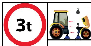
3. Toujours utiliser le bloc de sécurité situé au bas des chandelles pour fixer les parties du tracteur sur le rail afin d'éviter tout accident.
