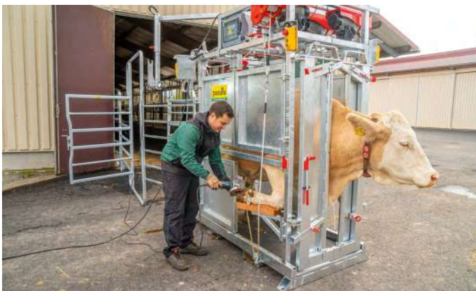
Comfortabele klauwverzorging dankzij elektrische lieren
