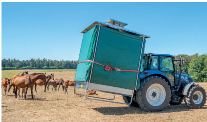
Transport über Dreipunkthanhängung, ungefüllt mit max. 10 km/h, mit eingeklappten Dachsegmenten
