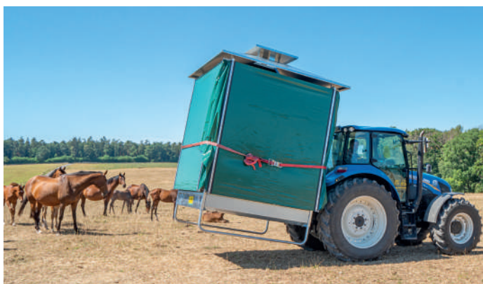
Transport à vide avec l'attelage 3 points et les parties latérales rabattues (max. 10 km/h)
